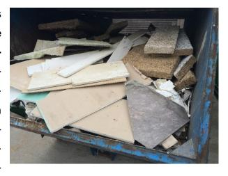
zementplatten (Heraklith), Spiegel- und Fensterglas, Glasbausteine mit Einfärbung, Schamott & Kaminsteine (versottet), Schlackenschüttmaterial.
